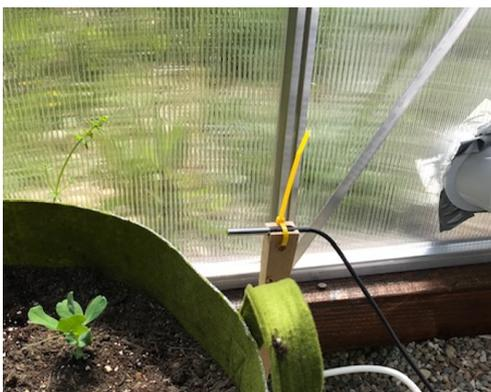
Der Aussenfühler muss sehr grosszügig abgedeckt werden - wir haben das mit einem Alublech gemacht (siehe Foto). Aufsteigende Wärme muss weichen können, und der Fühler sollte immer im Schatten sein.
