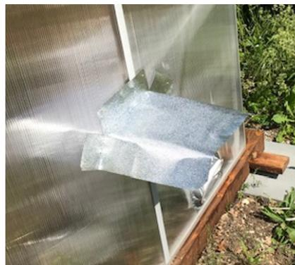
Das Loch für den Fühler gut abkleben, da der Fühler sonst durch die Druckunterschiede schnell mit Luft von innen umströmt wird und falsche Messwerte liefert.
